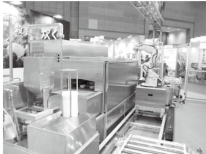
エースシステムは「過熱水蒸気による無浸漬炊飯システム」のパイオニア。担当者が世界初と胸を張る、過熱水蒸気で炊飯・調理するSRM (スチームライスマシーン)、小型調理機BMC (ボックスマルチクッカー) というシステムを新開発した。
