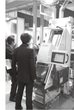
大勢の来場者の目をくぎ付けにしていたのは、2021年デビューの新製品で、美しさとスピードをあわせ持つ米のシュート式光選別機「SLASH」。赤外線カメラとフルカラーカメラによる2段階選別の後、不良品や異物をピエゾバルブで噴射し除去していた。
