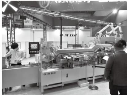
自動包装機械の製造販売を手がけているオーエム機械は、業界初のカートン補給作業自動化を実現した「VEカートン補給装置」をカートニングマシンにオプション搭載して展示。FOOMA JAPAN 初披露とあってブースは連日黒山の人だかりで、特に食品・製菓・冷食・冷菓業界の来場者の注目を浴びていた。同機は省スペース設計により据え付け面積が従来型の2/3になった連続型カートナーの決定版。担当者は「最新の人協働ロボットを用いたカートン補給作業自動化装置とともに、包装ラインのさらなる自動化・省人化を達成し、人手不足の解消と人件費削減に貢献します」とにこやかに語ってくれた。
