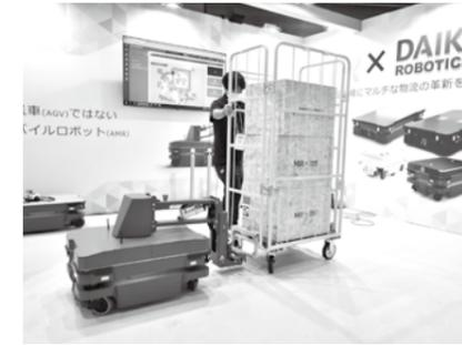
大喜産業の展示ブースでは、食品工場や物流倉庫で採用されている「自律モバイルロボット (AMR)」によるカゴ車の牽引・搬送のデモンストレーションを披露。AMRの最新の牽引ロボット「MiR (ミア) 250HOOK」は最大牽引能力500kg、最高時速7.2kmで、人やモノが行き交う工場・物流倉庫で自律的にそれらを回避し目的地へ荷物を運ぶことができる。「台車の移動などの単純作業をロボットに任せ、人にしかできない作業に人を投入する」という効率化を来場者の視覚に訴えていた。「将来、多くの企業が労働者人口の減少に伴う社会的課題に直面します。大喜産業はロボットビジネスおよび自動化の提案をさせていただくことでお客さまの不安を解消いたします」(担当者)。
