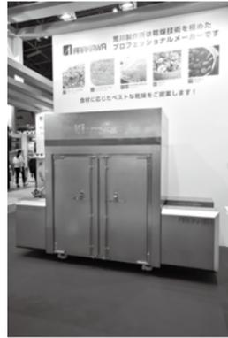
愛知県名古屋に本社を構える荒川製作所は、乾燥・焙煎・焼成といった熱風による熱処理に特化した総合乾燥機メーカー。今回出展のジェットチューブ・テクノロジーという熱処理システムを用いた「THERMOZONE (サーモゾーン) 乾燥機・焼成機」の特長は、「高速かつ均一な熱風を製品に当て、ムラなくかつ短時間で製品を仕上げることができる」こと。コンベア上の製品に熱風を均一に当てることで、割れや色つきなどの不良を防ぎ、香りや風味といった製品の特長を活かした熱処理が可能となる。
