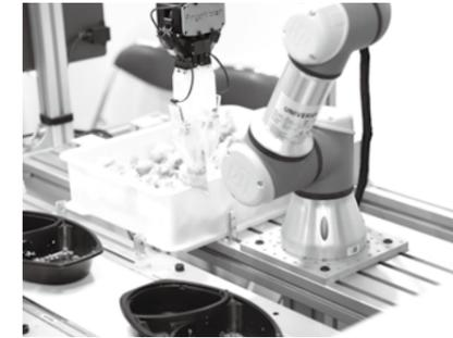
大学発の先進技術である「触覚センサ」をロボットアームに取り付けることで、これまで困難とされてきた食材盛り付け工程の自動化を行うFingerVision。そのブースで実演されていたのは、さまざまな形の唐揚げを的確にキャッチするロボットの姿だった。
