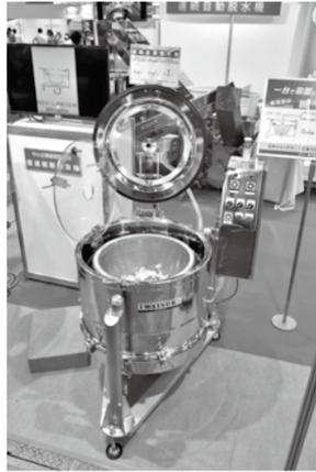
遠心脱水機の専門メーカー・岩月機械製作所の展示ブースの見どころは、電解水や冷水を給水し、そのまま脱水まで自動で運転する「KM-SW-V2型」。ざるかごを移し替えることなく、1台で殺菌・冷却処理までできる同製品の利点は、「少量の電解水で殺菌効果が得られる」と、「大幅に節水、労力軽減のできる省エネ機」であること。脱水時の二次汚染がなくサニタリー性抜群のこのコンパクト脱水機は、野菜、水産物、肉類などを扱う食品業界関係者の注目を浴びていた。
